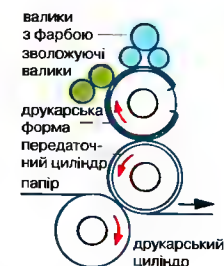
Офсет Друкарська форма, встановлена на друкарському циліндрі
